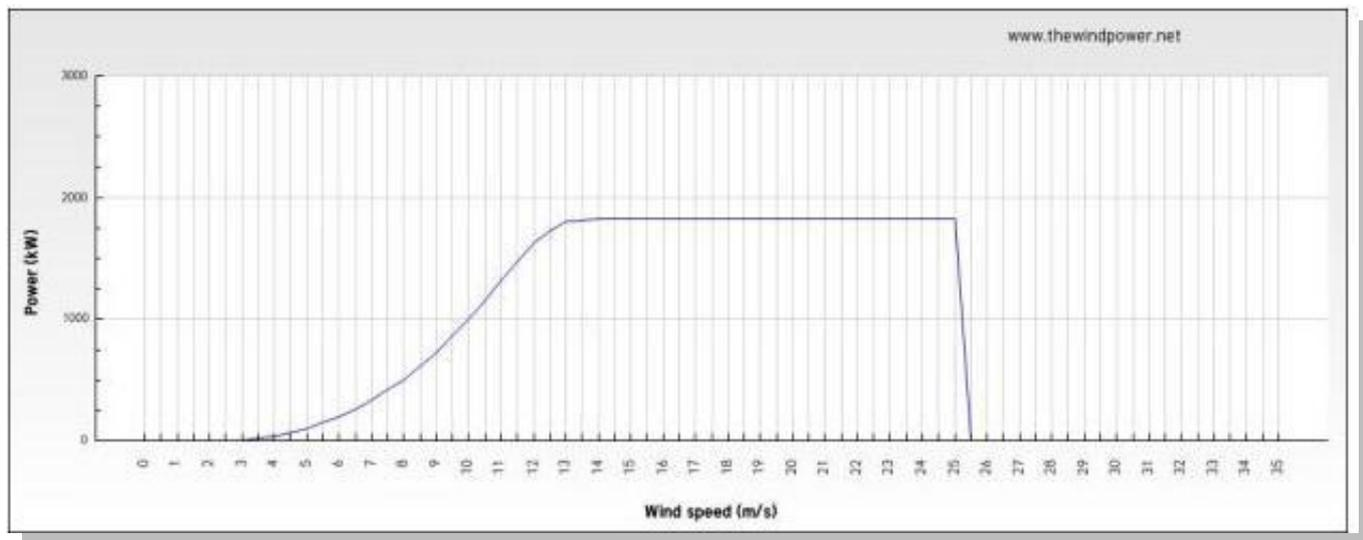
Рисунок 1.6 – Кривая производительности ВЭУ Enercon E-66 18.70 (1000 кВт)
