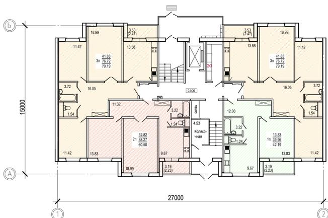
Схема плана типового этажа (одна секция)
