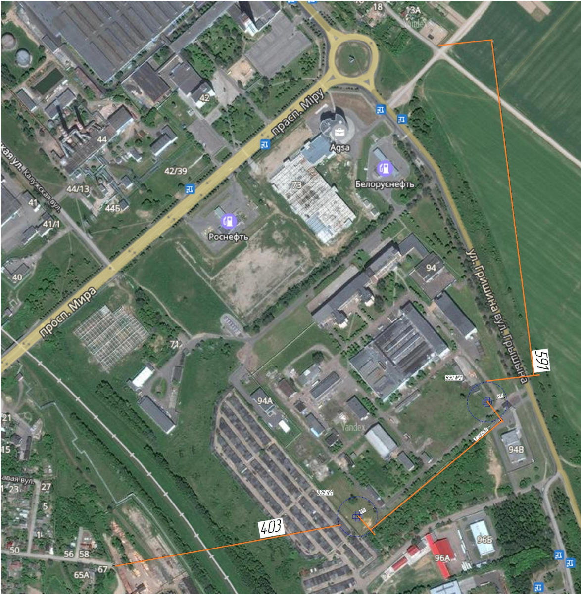
Рис. 1.4 – Схема размещения ВЭУ относительно жилой зоны
